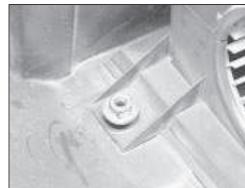
16.5a Heater fan motor retaining nut
