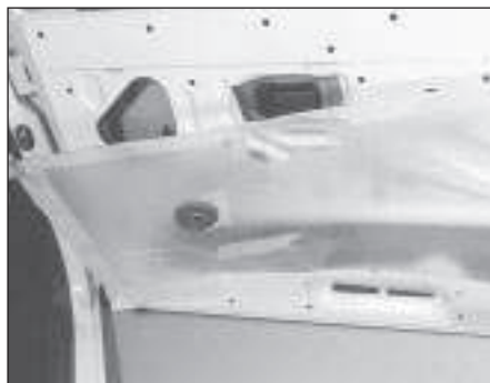
14.38 Peeling back the door waterproof sheet
