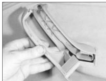
10.2A Remove the door handle trim capping . . .
