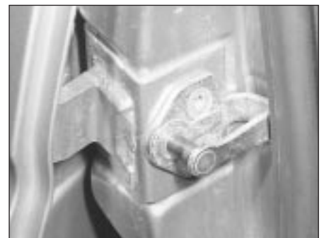
16.5 Door striker - note Torx-head securing bolt
