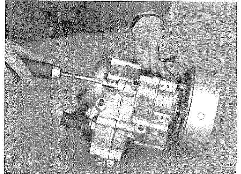
— Au moyen d'un tournevis, visser ou dévisser l'axe de commande jusqu'à ce que la gorge de verrouillage se trouve exactement dans l'axe du logement de la bille et du ressort.
