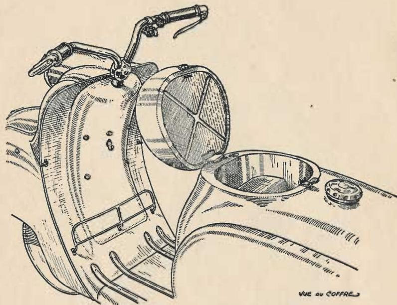
Pour les retirer, écarter l'extrémité du ressort à lame vers l'arrière, et soulever fermement, par la poignée située sur le panneau.
