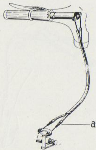
Fig. 74. - Réglage des commandes du changement de vitesses.
