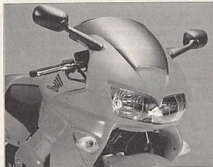
△ Les techniques nouvelles permettent d'obtenir des phares aux formes de plus en plus compliquées. Ici le double optique dit " en forme d'oeil de chat " est équipé de réflecteurs à surface complexe
