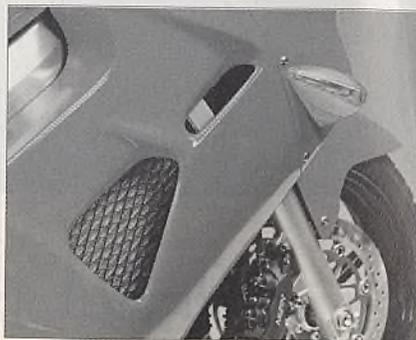
◄ Afin d'accroître l'effet venturi pour permettre une meilleure évacuation de l'air chaud circulant au travers des deux radiateurs latéraux, le carénage de la VFR 800 FI reçoit de larges ouïes d'aération.
